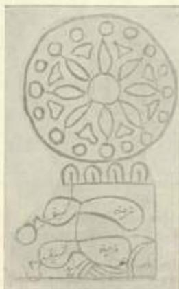
An der oberen Figur steht nichts. An der unteren steht in den Kürbissen „Kürbis“; in den angesetzten Stücken „*Anbíq*“; links unten steht „Rezipient“; rechts unten „Türe“.
