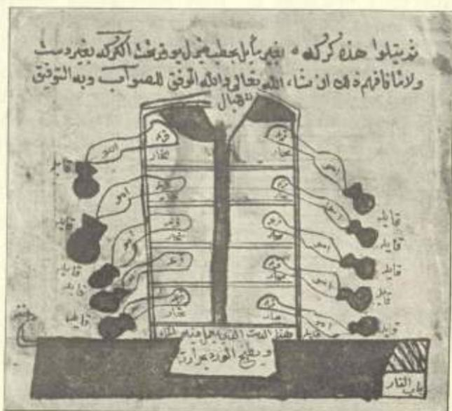
Rechts unten ist die Feueröffnung, die Verbrennungsgase entweichen aus dem Rohre links unten. In dem Kessel, Becken befindet sich Wasser, das die Retorten umspült und dessen Dämpfe oben entweichen. Die anderen Teile ergeben sich aus der Beschreibung.
