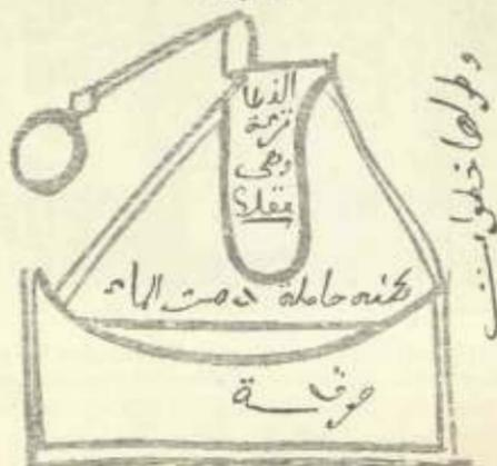
Unten ist der Feuerherd, in der Schale das verdampfende Wasser, oben die Cucubits mit Helm und Vorlage.
